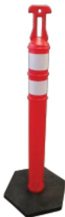
Alineador vial; utilizado como elemento de seguridad multi propósito. / Útil en carreteras, avenidas, caminos, rutas, circuitos, estacionamientos o restringir de zonas. / Autosoportable y alta estabilidad. / Con protección contra rayos UV. / Base hexagonal fabricada en 100% hule reciclado de neumático. / Con 2 cintas reflejantes de alta calidad reflectiva. / Con copete porta lámpara.
