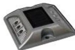
Reflejante que cumple con las normas nacionales e internacionales. / Páneles solares de la mejor calidad. / Orificios para clavos o tornillos. / Resiste hasta 20 T0. / El reflejante se encuentra incrustado en el aluminio para evitar que se rompa con los impactos. / Sistema que regula la presión que ejercen los autos cuando pasan sobre ella, para amortiguar el impacto.
