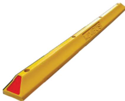
Adecuado para delimitar o confinar carriles exclusivos de autobús, metrobús o trolebús. / Moldeado por procesos de inyección a baja presión. / Protección contra rayos U.V. Resistencia a humedad y cambios climáticos. / Elaborados en una sola pieza. / Fácil instalación. / Se fija al piso con 4 anclas. / Con dos áreas reflejantes el frente y dos grandes áreas de reflejante por un solo lado, brindando gran visibilidad hacia los automovilistas. / Con logo (opcional) o el logo de su municipio.
