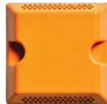
Principalmente se usa para delinear carriles en avenidas de uno o dos sentidos. / Máxima visibilidad con 43 esféras. / Fabricada a una sola pieza en materiales altamente resistentes y debido a sus grandes áreas reflejantes, cuenta con excelente visibilidad. / Resiste perfectamente cientos de atropellamientos. / Colocación por medio de pegamento epóxico. / Disponible con o sin perno según requerimiento del cliente.
