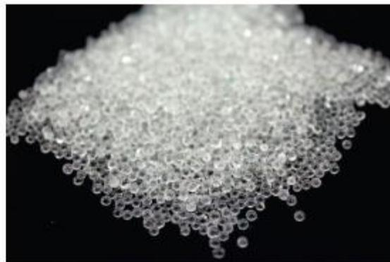
Esferas de vidrio transparentes, limpias e incoloras, lisas y de forma esférica libre de manchas lechosas. Especialmente utilizada para combinarse con pintura sobre la carpeta asfáltica, para producir reflexión en el pavimento.
