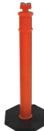
Moldeo rotacional con polietileno de media densidad, de alta resistencia y con protección a los rayos UV. / Alineador vial; utilizado como elemento de seguridad multi propósito. / Útil en carreteras, avenidas, caminos, rutas, circuitos, estacionamientos o restringir de zonas. / Autosoportable y alta estabilidad. / Ideales para condiciones corrosivas del ambiente. / Base octagonal de Neopreno o rotomoldeo para soporte.
